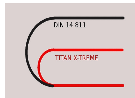
Biegeradius Vergleich DIN/TITAN X-TREME
