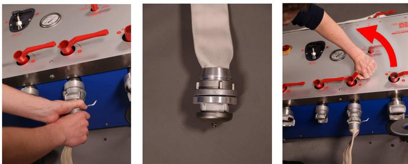
Zu prüfenden Schlauch an Prüfabgang anschließen.
