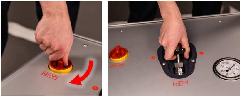
Hauptschalter der Hochdruckpumpe einschalten.
