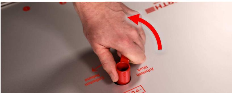
Entlastungsventil öffnen um Druck im Prüfsystem abzubauen.
