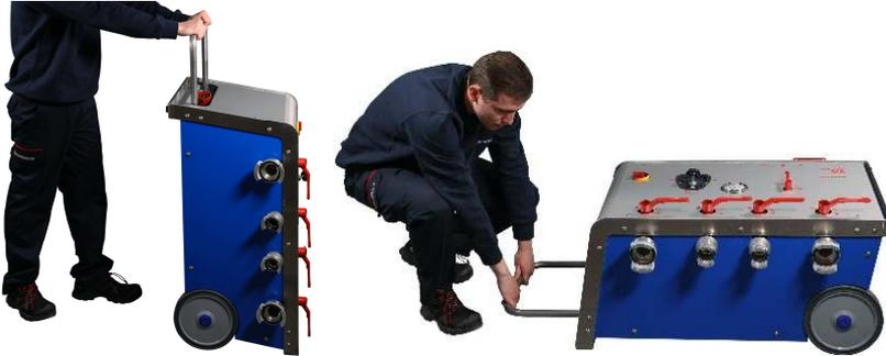
Schlauchprüfpumpe an gewünschten Betriebsort in Position bringen und auf dem Boden ablegen. Elektrische Zuleitung einstecken.
