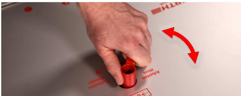
Prüfpumpe am Entlastungsventil entlüften.
